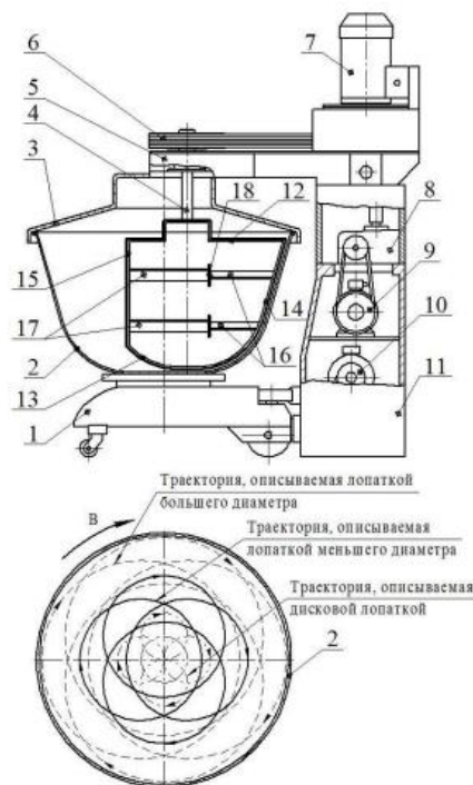
Рисунок 2. Общий вид модернизированной тестомесильной машины
